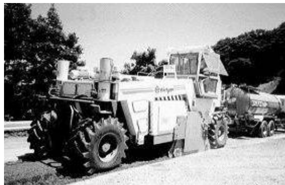
写真－１ 路上破碎混合機（供給車併走タイプ）
